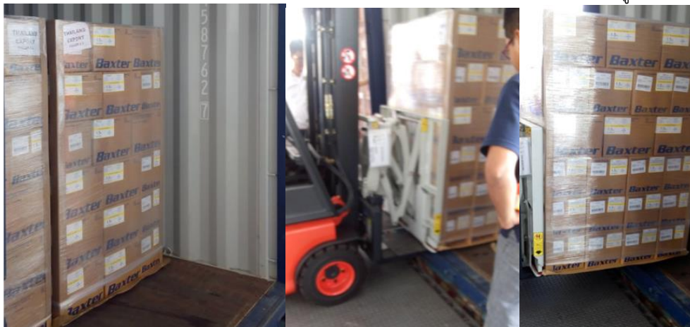
รูปภาพที่ 3-3 สินค้าที่ไหลโดยการใช้สลิปซีท
