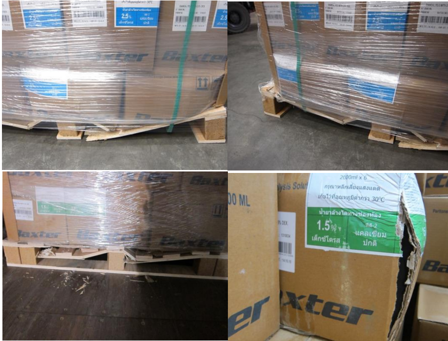
รูปภาพที่ 3-2 ความเสียหายจากการแตกหักของไม้พาเลทระหว่างขนส่ง
